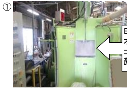
加圧ニーダーに原料投入
