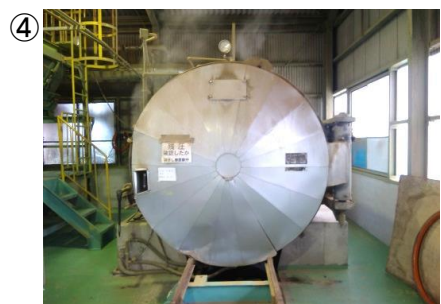
加硫缶の中で加硫させる
