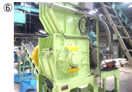
粉碎機で細かく粉碎(粒径1~3mmが主流)
